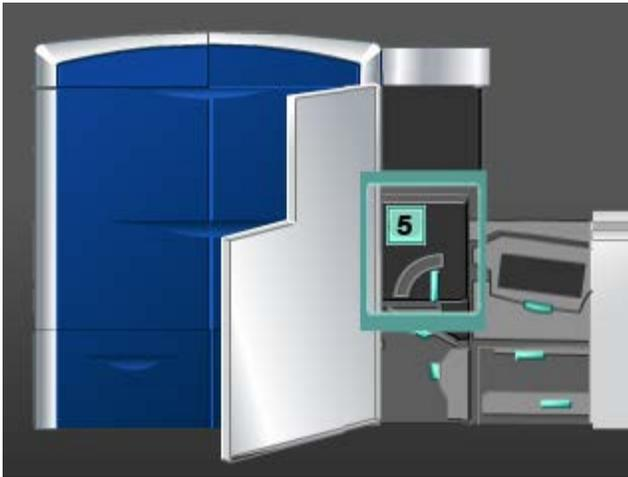
1. Ouvrir le panneau avant gauche (moteur d'impression à droite).
