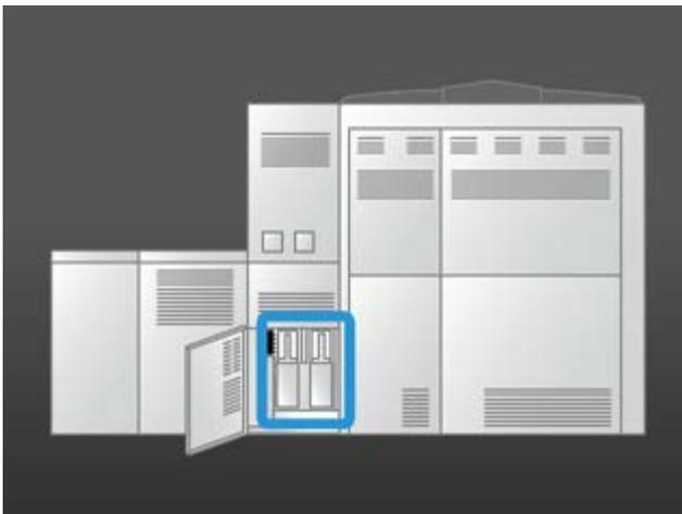
Lorsqu'un contenant est plein, un message apparaît sur l'interface utilisateur avertissant qu'il faut remplacer le contenant. Comme il y a un deuxième contenant, la machine poursuit l'impression tant que le second contenant de récupération n'est pas plein. Cela permet de remplacer le contenant plein par un contenant en cours d'impression.
