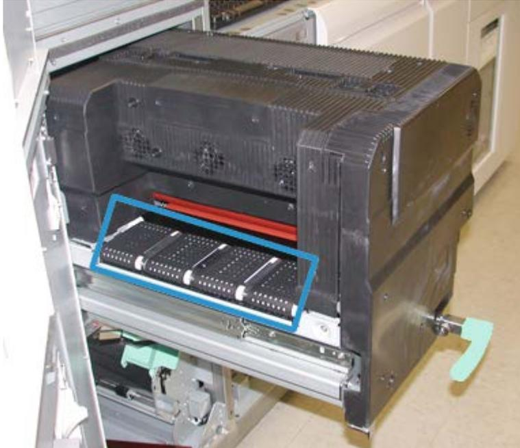
Continuer de tourner et de nettoyer les courroies jusqu'à ce que celles-ci soient propres.
