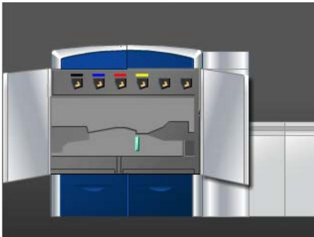
2. Utiliser un chiffon humide, humecté avec de l'eau (non mouillé), non pelucheux, pour nettoyer le circuit support uniquement dans les zones de dégagement d'incident du levier vert, comme indiqué ci-dessous.
