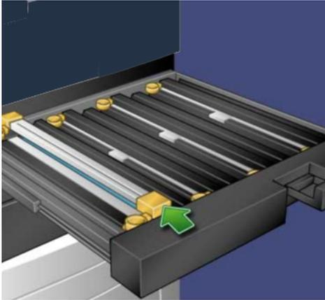
8. Para extraer el corotrón de carga viejo, sujete los contenedores de color ámbar de los extremos del corotrón de carga y levántelo suavemente.
