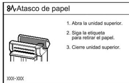
1. Levante la palanca de liberación de la unidad superior para abrir la unidad superior.
