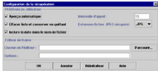
**Intervalle d'appel** – Choisir le laps de temps en secondes entre chaque interrogation automatique, où les images numérisées sont automatiquement extraites du scanner vers la fenêtre Récupération de document. La plage se situe entre 15 et 3 600 secondes.
