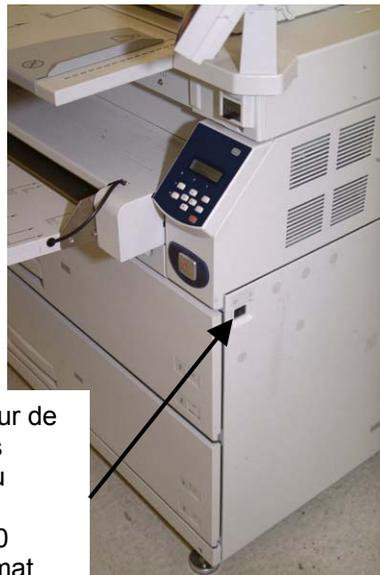
Interrupteur de mise sous tension du Xerox 6030/6050 grand format
