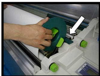
8. Coloque el tapón del extremo derecho en la posición que corresponda al ancho del material de impresión. Las guías delanteras son rodillos de soporte que giran libremente.
