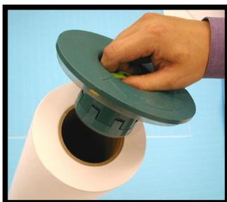
2. Inserte un tapón en un extremo del nuevo rollo de material de impresión hasta que quede asentado firmemente, cuidando de no dañar el otro extremo expuesto del rollo. Para obtener los mejores resultados los tapones de los extremos deben quedar ajustados sin forzarlos en el rollo.
