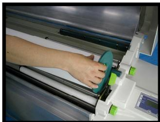
7. En el alimentador del rollo de material de impresión de la impresora hay guías para el ancho del material de impresión.
