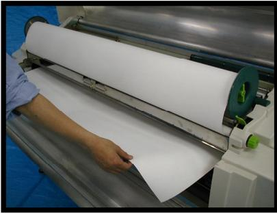
3. Si el atasco ocurrió antes de que se expulsara el material de impresión por la salida, tire del material para cortarlo con facilidad.
