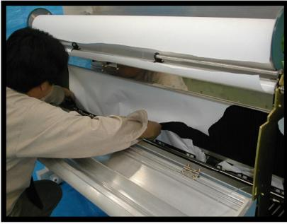
2. Retire con cuidado el material de impresión atascado de la unidad del cortador.
