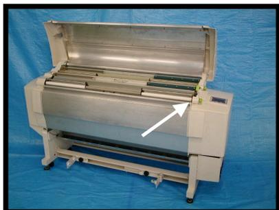
Cuando cambie los rollos de material de impresión, no use la palanca en el lado derecho de la impresora, déjela cerrada.
