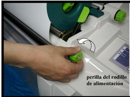
11. Gire la perilla del rodillo de alimentación hacia usted. Continúe avanzando el material de impresión hasta que oiga un pitido procedente de la impresora. La impresora detectará el borde anterior del nuevo material de impresión. Asegúrese de que la tensión del material de impresión sea uniforme y que no se arrugue.
