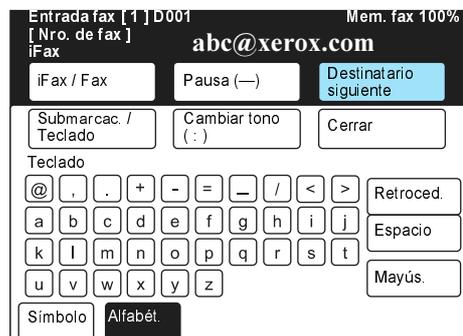
5. Seleccione **iFax/Fax** para que aparezca “iFax” en el área de mensajes. Introduzca la dirección electrónica.
