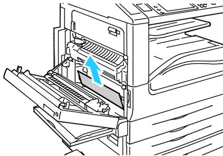
3. Fixiermodul durch Herausziehen des Griffs A1 öffnen.
