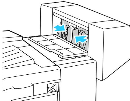
3. Die Griffe an beiden Seiten des Heftklammermagazins halten und das Magazin aus dem Finisher herausziehen.
