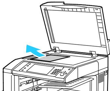
8. Wenn die Vorlage nach Öffnen der Vorlagenabdeckung nicht sichtbar ist, Vorlageneinzugsfach anheben und Papier entfernen.
