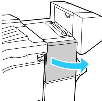
2. In das Finisherfach greifen und den Hefter bis zum Anschlag herausziehen.
