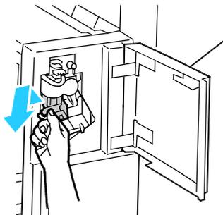
5. Das Innere des Finishers auf lose Heftklammern überprüfen und diese ggf. entfernen.
