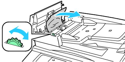
4. Wenn die Meldung anweist, die innere Abdeckung zu öffnen, Hebel mit der grünen Lasche anheben, um die innere Abdeckung zu öffnen.
