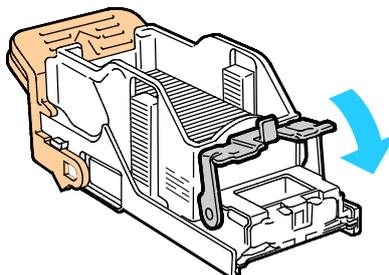
9. Das Heftklammermagazin am orangefarbenen Griff in die Heftereinheit einschieben, bis es einrastet.
