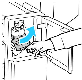
4. Heftklammermagazin am orangefarbenen Griff fassen und fest nach vorne ziehen und entfernen.
