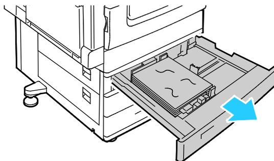
5. Zerknittertes Papier aus dem Behälter entfernen.
