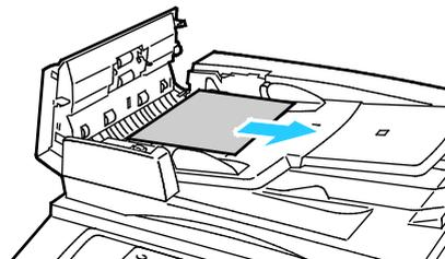
3. Wenn am Steuerpult dazu aufgefordert wird, das grüne Rad zu drehen, dieses in der gezeigten Richtung drehen. Durch Drehen des grünen Rades wird die Vorlage aus dem Einzug entfernt.
