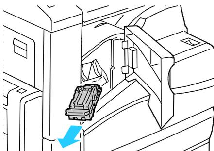
2. Lose Heftklammern und Schmutz aus dem Finisher entfernen.
