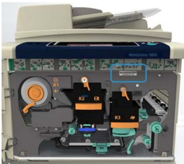
1. Pour obtenir ce numéro, ouvrez la porte avant de la machine. Il est indiqué sur une étiquette au-dessus du module four.
