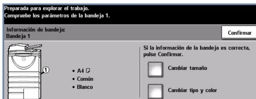
Para la bandeja especial y las bandejas de papel 1 y 2, seleccione el botón **Confirmar**, o bien, si ha cambiado el tamaño, el tipo o el color del papel, seleccione los botones **Cambiar tamaño** o **Cambiar tipo y color** para reprogramar la bandeja.
