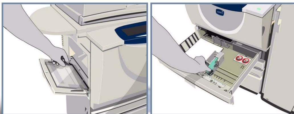
Para la bandeja especial y las bandejas 1 y 2, **ajuste las guías** de modo que toquen ligeramente el borde de la pila de papel.
