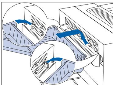
**18** Enganche el compartimiento cara arriba en el módulo dúplex, asegurando la parte saliente del módulo dúplex en la abertura del lado izquierdo del compartimento. Asegúrese de que el compartimiento cara arriba esté bien fijado.
