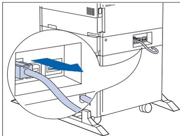
**3** Desconecte el cable de conexión de la impresora.
