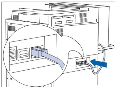
**12** Conecte el cable de conexión en la impresora.
