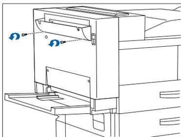
**4** Afloje y retire los tornillos, extraiga el soporte del compartimiento cara arriba.
