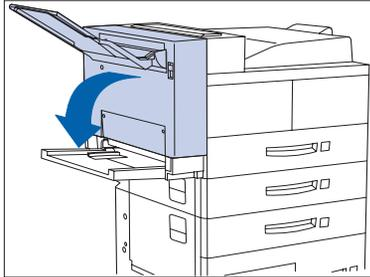
**2** Abra la cubierta interior del módulo dúplex.
