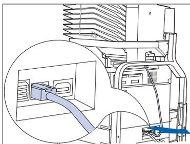
**3** Desconecte el cable de conexión del Buzón de la impresora.
