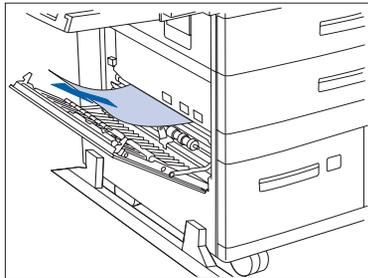
Siga este procedimiento para despejar un atasco del área C del alimentador de 2.500 hojas cuando el visor del Panel de control indica **Despeje área C**.
