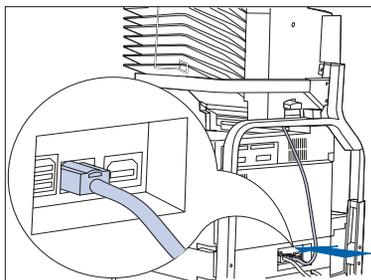
**14** Conecte el cable de conexión del Buzón a la impresora.
