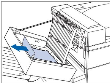
**4** Cierre la cubierta interior del módulo dúplex y, a continuación, cierre el módulo dúplex.
