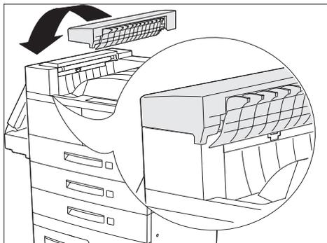
**6** Sitúese frente a la impresora y coloque la cubierta de transporte en el lado superior izquierdo de la impresora. Asegúrese de que el borde del lado inferior derecho de la cubierta de transporte esté colocado debajo del borde de conexión de la impresora.
