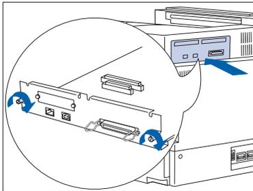
**5** Retire la tarjeta de interfaz levantándola suavemente del receptáculo de la clavija y sacándola de la tarjeta del controlador.
