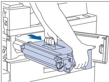
**3** Retire el cartucho para impresión láser. Deslícelo suavemente hacia fuera con la palanca ámbar y luego levántelo con la palanca superior.
