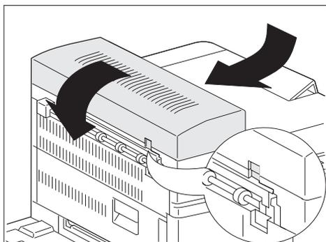
**7** Alinee las lengüetas de la cubierta de transporte con las ranuras adecuadas en el borde de la impresora, como se muestra.
