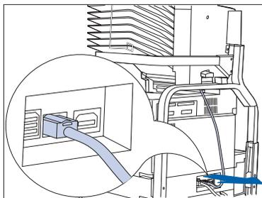
**4** Desconecte el cable de conexión del Buzón de la impresora.
