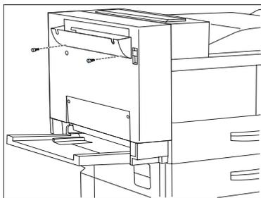
**17** Instale el soporte del compartimiento cara arriba en el módulo dúplex y apriete los tornillos.
