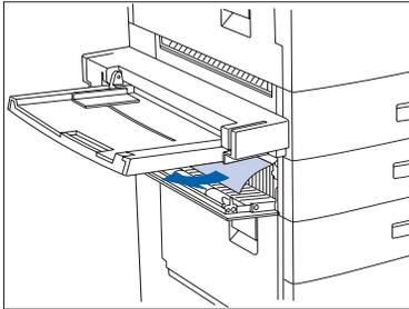
Siga este procedimiento para despejar un atasco del área B de la impresora cuando el visor del Panel de control indica **Despeje área B**.
