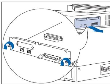
**3** Afloje los tornillos y retire la tarjeta del controlador. Colóquela en una superficie plana.
