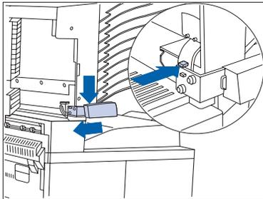
11 Presione el botón indicado y retire la palanca azul desde el buzón/clasificador empujando la palanca hacia abajo y hacia la izquierda.
