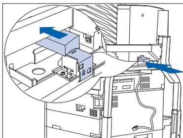
**10** Introduzca la palanca en la parte posterior (atrás) del retén del buzón/clasificador como se muestra.
