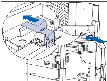
12 Introduzca la palanca en la parte posterior (atrás) del retén del buzón/clasificador como se muestra.
