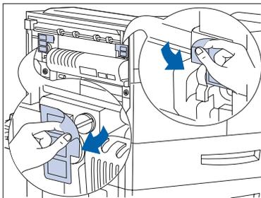
**30** Deslice la cubierta para abrirla y dejar ver los tres rodillos de alimentación para la bandeja 5.
