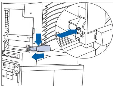
**9** Presione el botón indicado y retire la palanca azul desde el buzón/clasificador empujando la palanca hacia abajo y hacia la izquierda.
