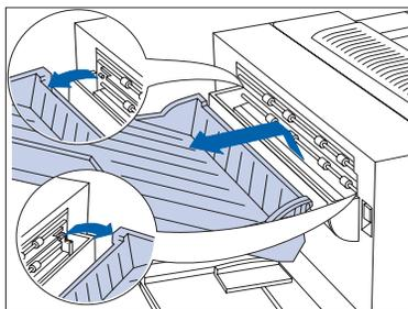
**3** Levante el compartimiento cara arriba para desbloquearlo y extráigalo del módulo dúplex.
