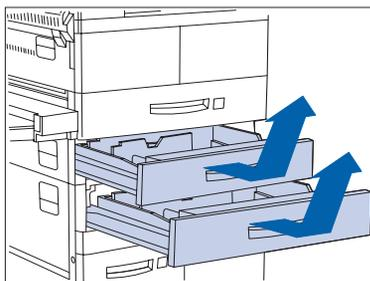
**4** Retire la bandeja 2 de la impresora, empujándola completamente y luego levantándola hacia afuera. Repita este procedimiento para la bandeja 3 en el HCF.
