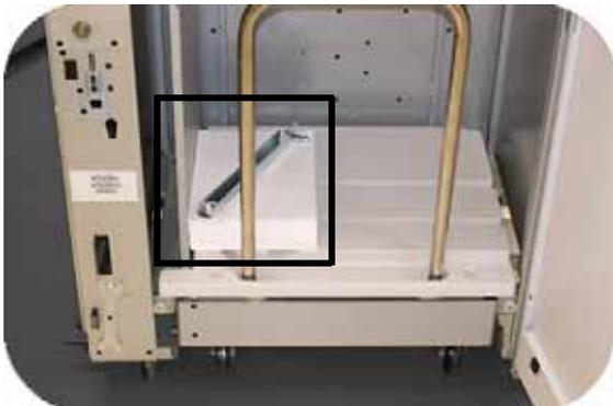
4. Tire del carro del apilador. Retire la barra aseguradora.
