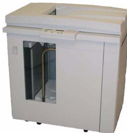
Le bac récepteur accepte 3 500 feuilles de 90 g/m<sup>2</sup> (24 lbs) de support médian (ou 370 mm limite haute). Le bac supérieur accepte 250 feuilles de support 90 gm<sup>2</sup> (24 lbs) de support médian. Le récepteur est fourni avec deux chariots de réception. Il est possible d'acheter un autre chariot de réception. Contacter le technicien Xerox pour obtenir d'autres détails.
