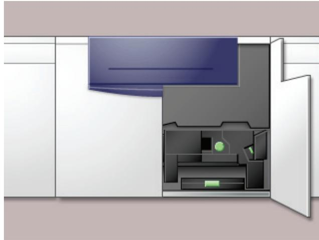
2. Placer un chiffon sur le sol en dessous de la zone du module four. Tout déversement d'huile sur le sol rendra ce dernier glissant.
