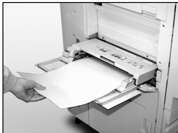
Figure 3 : Mise en place des supports dans le magasin 5
