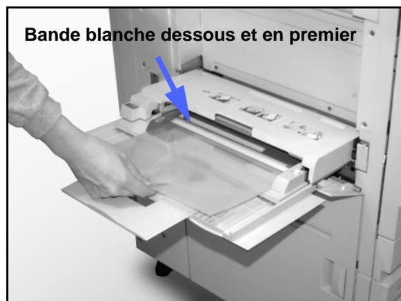
**Figure 4 : Mise en place de transparents dans le magasin 5**
