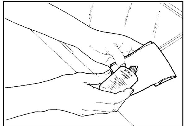
Figure 2 : Humidification d'un chiffon non pelucheux
