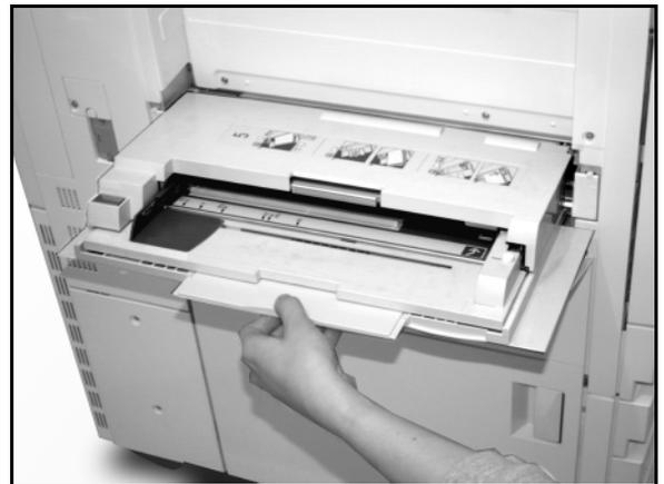
Figura 11: Sujeción de la lengüeta de la bandeja de papel 5
