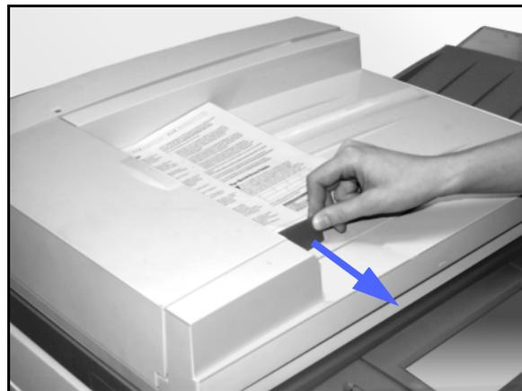
**Figura 8: Deslizamiento de la guía de documentos**
