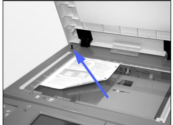
**Figura 13: Colocación de un documento en cristal de exposición**
