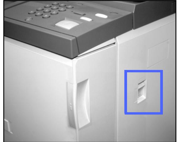
**Figura 1: Interruptor de la corriente en posición de apagado**
