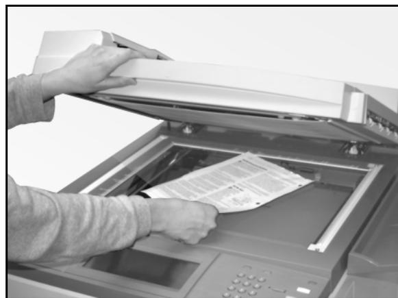
**Figura 9: Alimentador automático de documentos a dos caras levantado**
