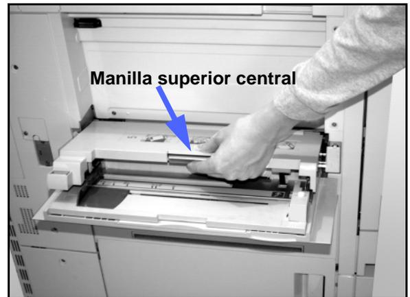
Figura 16: Modo de agarrar la parte superior de la bandeja 5
