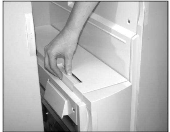
**Figura 2: Palanca liberadora de la clasificadora/torre de buzones**
