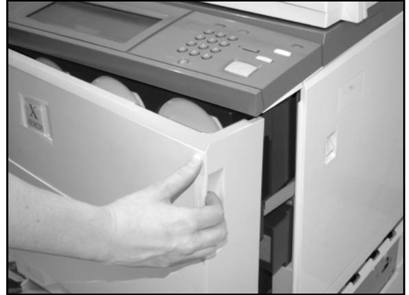
Figura 8: Modo de abrir la puerta delantera
