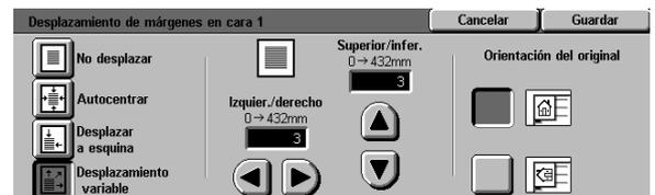
Figura 26: Desplazamiento de márgenes con la opción “Desplazamiento variable” seleccionada
