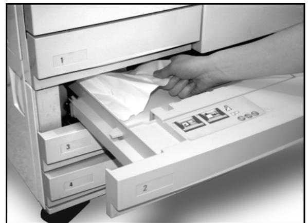
**Figura 15: Despeje de un atasco de papel en el interior de una bandeja de papel**
