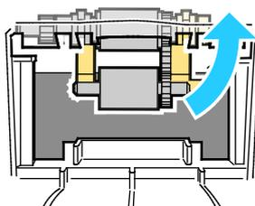
5. Réinstallez le rouleau de séparation. Pressez les deux languettes extérieures et poussez le rouleau dans l'ouverture jusqu'à ce que ses deux extrémités s'enclenchent dans leurs logements.
