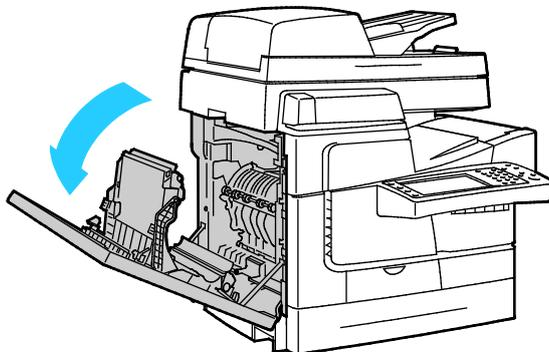
2. Soulevez la poignée du guide de sortie et maintenez-la dans cette position jusqu'à la fin de l'étape suivante.
