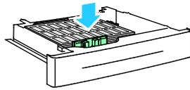
3. Réglez les guides de largeur pour les mettre légèrement en contact avec les bords du papier.
