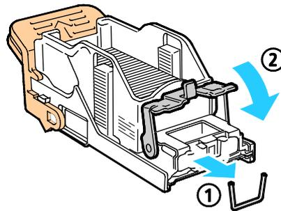
5. Saisissez la cartouche d'agrafes par la poignée orange et insérez-la dans l'ensemble agrafeuse. Poussez-la jusqu'à l'enclenchement.
