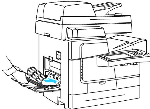
3. Réglez les guides de largeur pour les mettre légèrement en contact avec les bords du papier.
