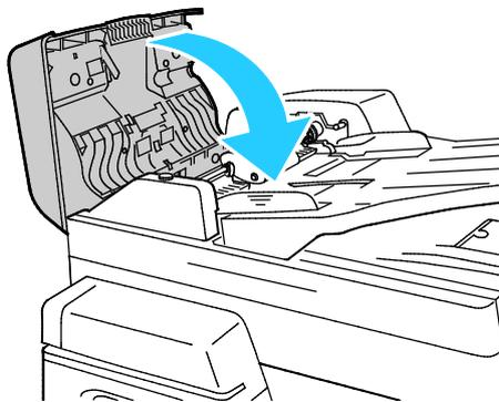
4. Si l'original n'est pas visible à l'ouverture du capot supérieur du chargeur de documents, soulevez le cache-document et retirez l'original.
