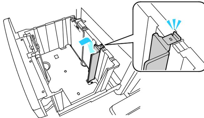
**Remarque :** Ne forcez pas sur le guide pour le mettre en place. S'ils sont alignés correctement, la languette supérieure s'insère dans son logement sur simple pression.
