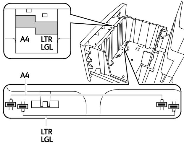
**Remarque :** Pour que la plaque se mette en place lors de l'alignement du guide avant, la languette du milieu doit être alignée correctement.
