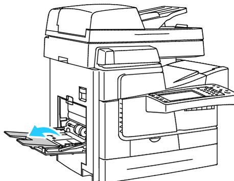
3. Insérez jusqu'à 10 enveloppes dans le magasin, alignez la pile, puis réglez les guides jusqu'à ce qu'ils touchent les bords de la pile.
