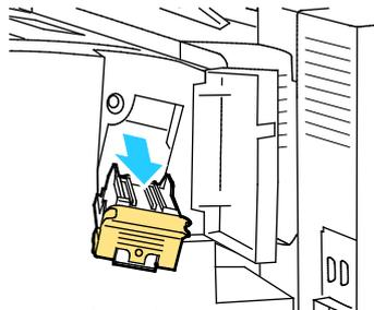
**Remarque :** Une cartouche d'agrafes se compose de deux éléments : une cartouche munie d'une poignée orange et une recharge d'agrafes. Ces deux éléments sont remplaçables par l'utilisateur. Pour plus d'informations, reportez-vous à [Remplacement des agrafes dans le module de finition 650 feuilles](#) à la page 179.
