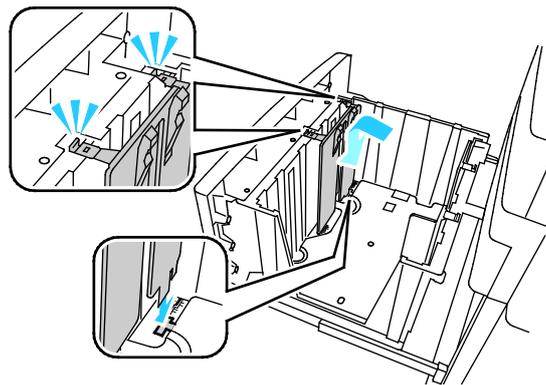
5. Pour déplacer le guide de largeur du papier arrière vers le format papier sélectionné, suivez les étapes 4a-c.
