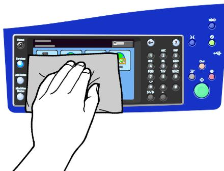
2. Utilisez un chiffon légèrement humide pour nettoyer l'extérieur du chargeur de documents, des bacs récepteurs, des magasins et les surfaces externes de l'imprimante.
